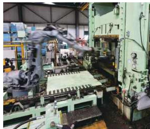
複雑な形状のサブフレーム骨格を大量生産していくハイドロフォーム Mass producing subframe with complex shapes using hydroforming
