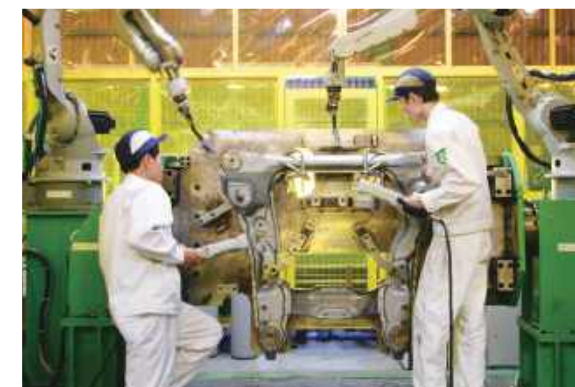
試作用溶接システム 量産性を考慮し、機能的な動きが得られるよう、プログラムしていきます。
