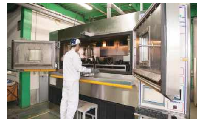
複合耐食試験装置 試作品や製品に対し、繰り返しさまざまな厳しい環境や負荷を与え、より良い製品づくりへと反映させる試験装置。 Complex anti-corrosion test system This test system repeatedly subjects the prototype or product to a wide variety of rough conditions and loads in order to manufacture a better product.
