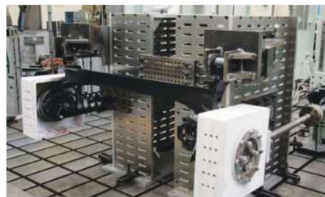
多軸加振試験装置 さまざまな力を加えることで、ねじれに対する強度を検証します。 Multi-axial vibration equipment Strength against torsion is verified by applying various forces.
