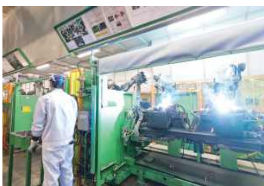
生産ラインの変化に対応する溶接ライン Welding lines that support production line changes
